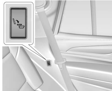
Interruptor del panel trasero del lado del conductor
